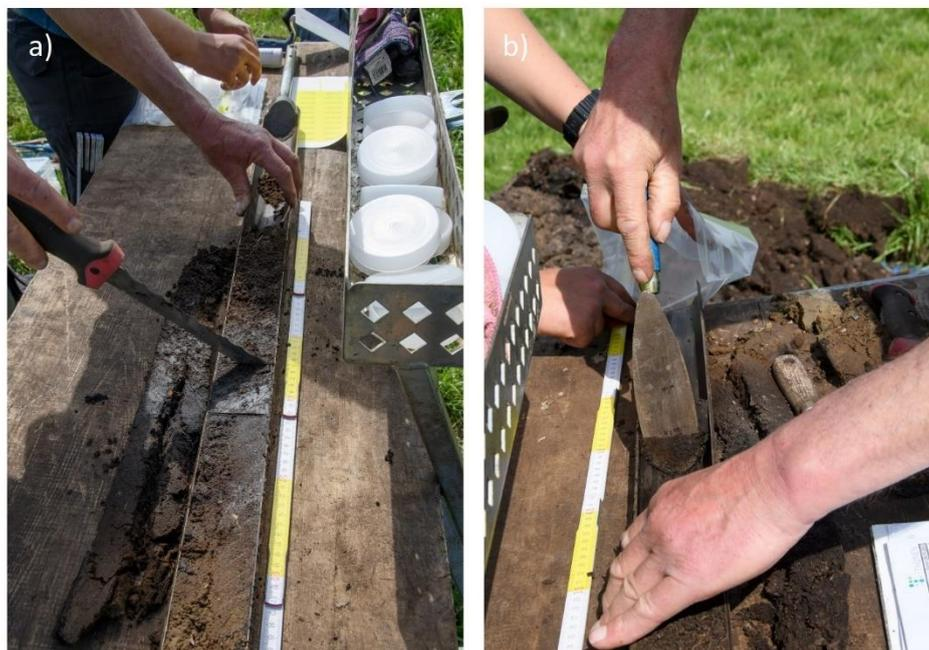
Die Beprobung endet mit Erreichen des mineralischen Untergrundes. Mineralbodenanteile in der Probe werden abgeschnitten und verworfen. Ist der Übergang zwischen dem Moorkörper und dem mineralischen Untergrund (z.B. C- oder G-Horizont oder fossiler Oberboden) nicht eindeutig zu erkennen, sollte zusätzlich eine Probe des Übergangsbereiches genommen werden.
